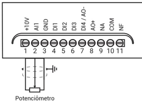
Figura 3.3.10 - Esquema de ligação do potenciômetro.
