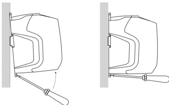
Figura 3.2.3. Detalhe para fixação no trilho DIN35.
