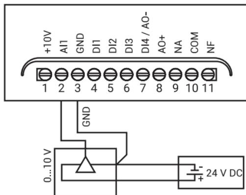
Figura 3.3.12 - Esquema de ligação de dispositivo externo via sinal de tensão.
