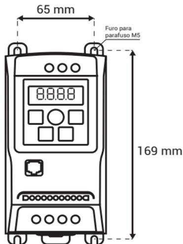
Figura 3.2.2. Dimensões mínimas para instalação mecânica.
