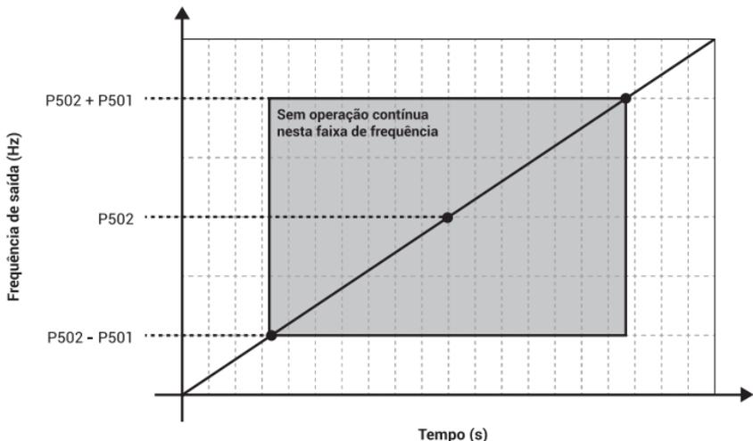
Figura 4.2.3 - Frequência a ser evitada e banda a ser evitada.
