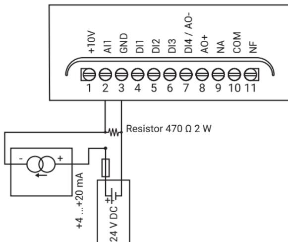
Figura 3.3.15 - Esquema de ligação de dispositivo externo via sinal em corrente.
