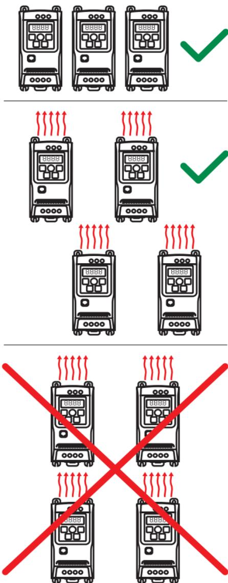
Figura 3.2.5. Boas práticas para instalação mecânica.
