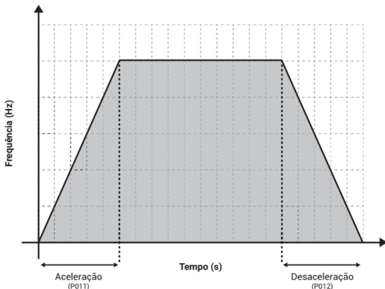
Figura 4.2.1 - Perfil de aceleração/desaceleração.
