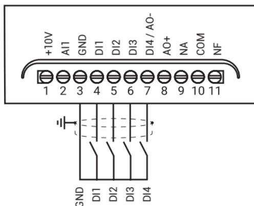
Figura 3.3.8 - Exemplo de ligação das entradas digitais.
