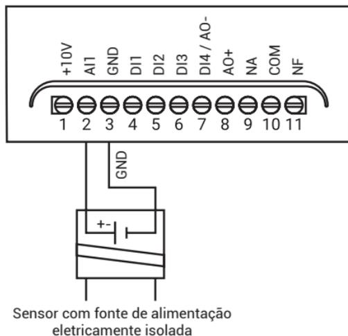
Figura 3.3.11 - Esquema de ligação de dispositivo externo via sinal de tensão.
