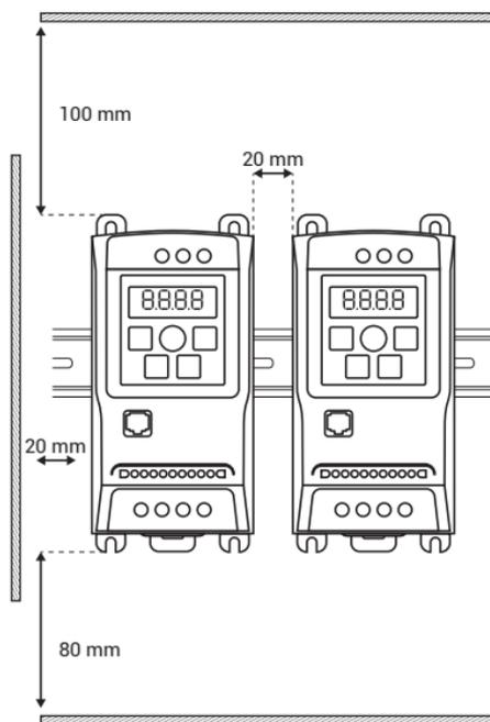
Figura 3.2.4. Detalhe para fixação no trilho DIN35.
