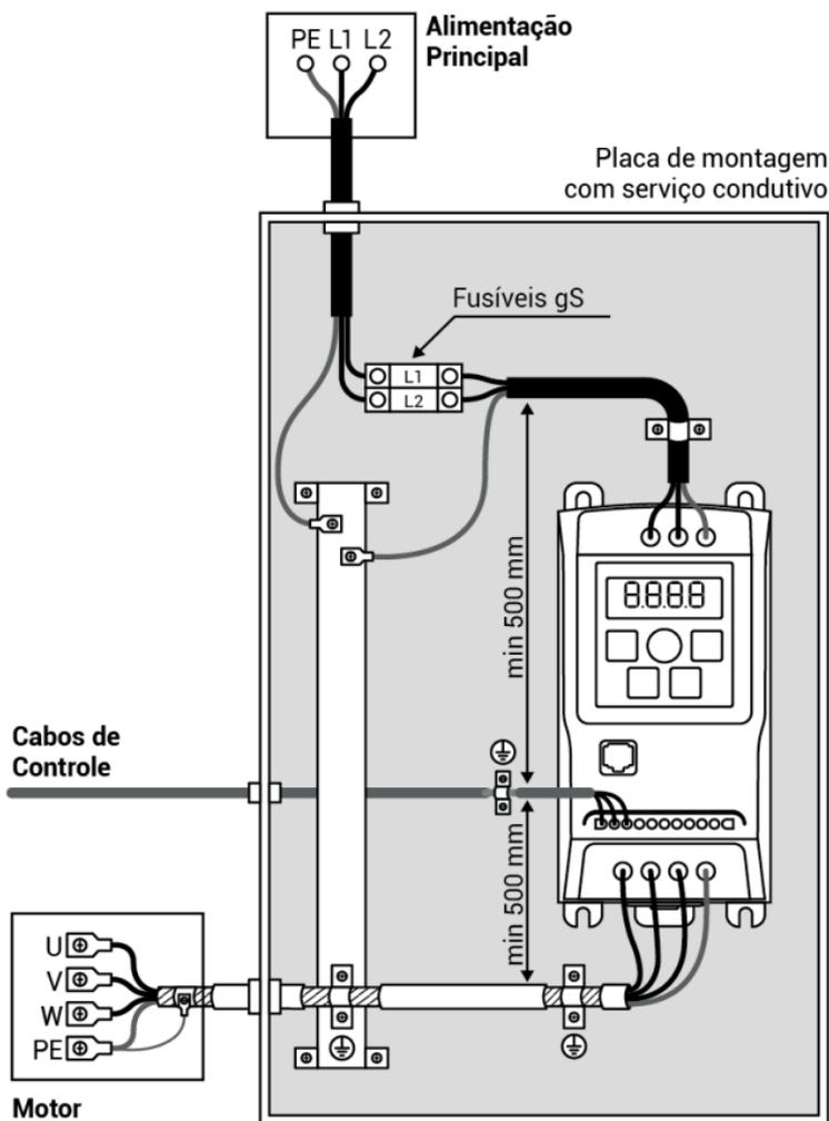
Figura 3.3.4 - Boas práticas para instalação em painel elétrico
